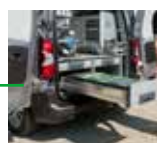
Tiroirs avec glissières extension totale 100% et charge maxi de 70 kg
